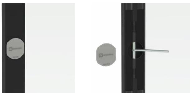
Usado de forma embutida dentro dos perfis verticais e estruturais da porta. A regulagem do desempenador é realizada através de chave de boca. Após, é aplicada a tampa de acabamento.
