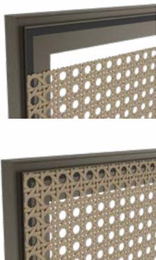
Ao utilizar o Baguete BA 16, posicionar a tela na moldura e aplicar o baguete por cima, utilizando parafusos.
