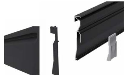
03. Após são aplicadas as ponteiras de acabamento dos perfis, através de encaixe lateral. Para cálculo de corte, devem ser descontados os 2mm da sua espessura.
