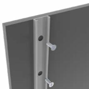
02. A fixação do suporte na parede, é feita através de parafusos.
