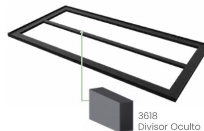
OBS: A cada um metro de comprimento, utilizar um divisor oculito com fita dupla face.
