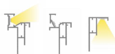
Montar a moldura externa com o perfil 9581 ou 9582 em corte de 45°. Junte os perfis, utilizando a cantoneira 20.
