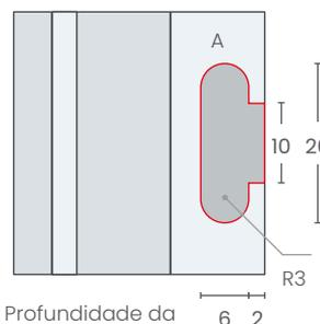
Profundidade da usinagem = 10mm
