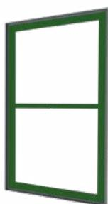
01. Montagem do quadro com o perfil 3555. Aplicar fita dupla face nos perfis superiores e inferiores.
