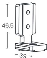
O fixador 95P deixa a cavidade do vidro livre, facilitando o uso, pois evita a necessidade de usinagens especiais.
