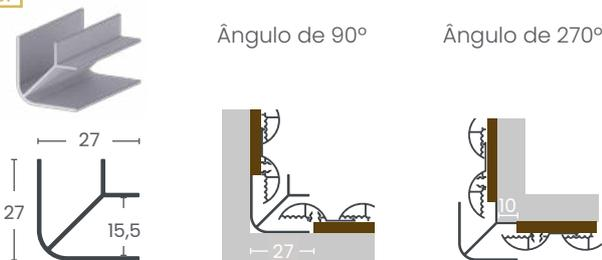
Fixação Parafuso - Adesivo
