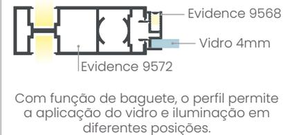
Com função de baguete, o perfil permite a aplicação do vidro e iluminação em diferentes posições.
