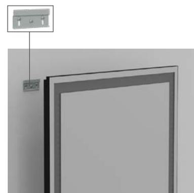
Fazer a união das duas molduras, utilizando parafuso com cabeça panela. Depois utilize as linhas de referência para facilitar o processo.
