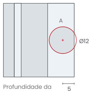
Profundidade da usinagem = 10mm
