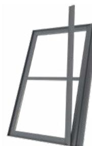
03. Respeitar o desconto de 5mm para realizar o encaixe dos perfis.
