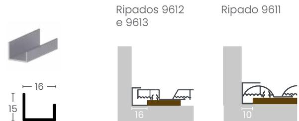
Fixação Parafuso - Adesivo
