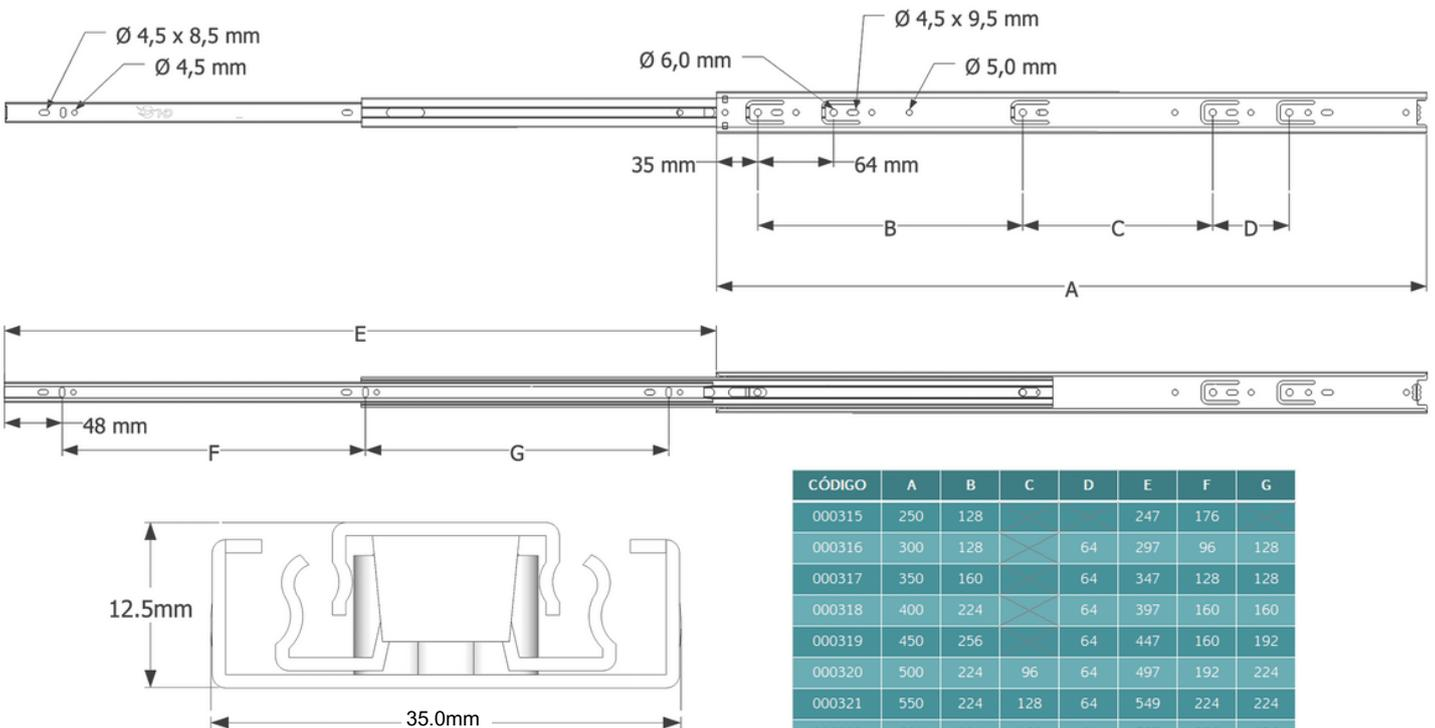
O trilho telescópico H42 possibilita a abertura total da gaveta com deslizamento suave, preciso e resistente. Sua praticidade com travas laterais permite a retirada da gaveta.
