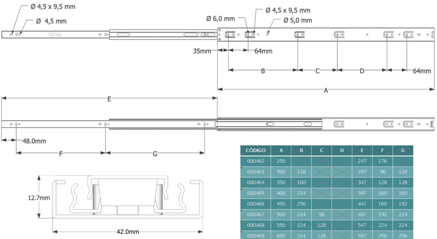
O trilho telescópico H45 possibilita a abertura total da gaveta com deslizamento suave, preciso e resistente. Sua praticidade com travas laterais permite a retirada da gaveta.
